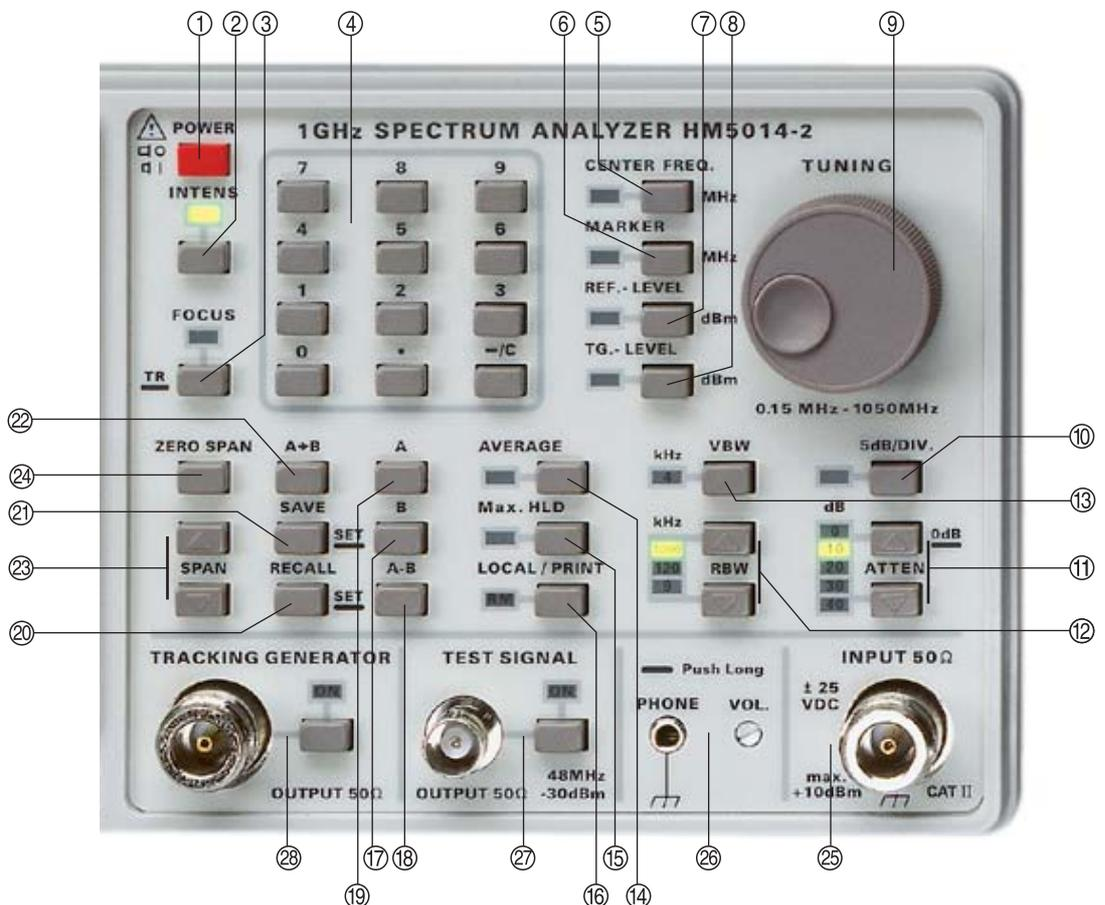
Bei aktivierter AVERAGE-Funktion wird eine mathematische Mittelwertbildung vorgenommen, bei welcher der Mittelwert aus dem Ergebnis der vorherigen Messungen und der aktuellen Messung gebildet sowie angezeigt wird. Aus dem Resultat der letzten Mittelwertbildung sowie der nächsten aktuellen Messung wird erneut der Mittelwert gebildet und angezeigt.
